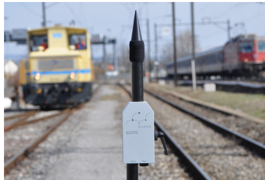
Das Messgerät zeichnet Werte von 20dB bis 130 dB auf und sendet diese via GSM/3G/LTE
